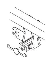
Colocar el tapón protector para evitar daños en el mecanismo.
