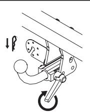
Girar la maneta hasta hacer presión. Colocar el pasador de seguridad en el extremo de la maneta.
