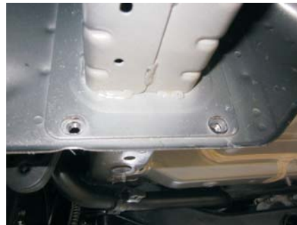
Detalle fijación piezas (5) y (6) al vehículo
